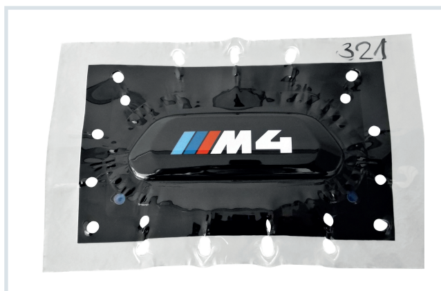
Bild 2. Zur Herstellung der hinterleuchteten Sportsitz-Blenden werden die vorgeformten Elektrolumineszenzfolien hinterspritzt © Arburg
